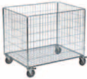
Ballwagen Metall ohne Deckel Elektrolytisch verzinkt, 4 graue Lenkrollen, 2 mit Bremse. Tragfähigkeit: 100 kg. Breite: 835 mm Tiefe: 625 mm Höhe: 740 mm WG503610
